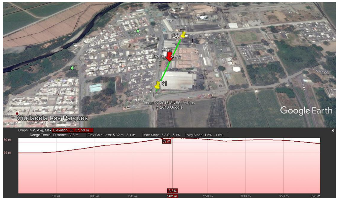
Figura 3.12: Perfil de elevación del enlace Panasa – Bomba 2 [32].
