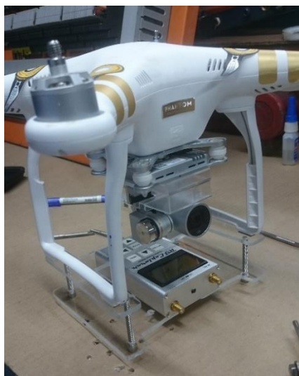
Figura 3.1: Elaboración de base para sujeción del analizador de espectro al dron.
