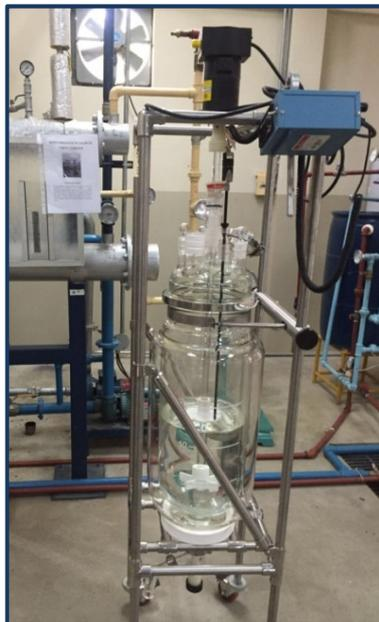
**Ilustración 5.** Reactor Batch en operación junto al intercambiador de calor.
