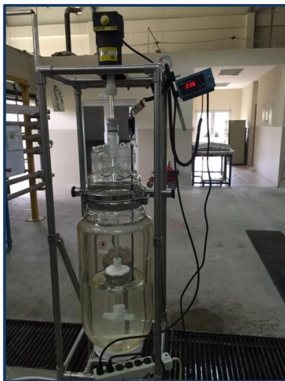
**Ilustración 6.** Reactor batch en operación – Esterificación del Etanoato de Etilo.
