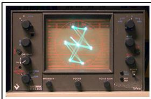
Figura 3.12 Imagen tomada de google- Representación de Crominancia en Vectorscopio
