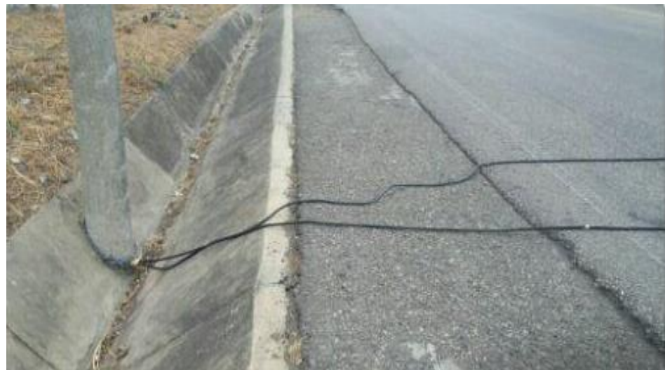
Figura 2.2 Sensores usados en el aforo Fuente: Lastra, K. Solórzano, G., 2017
