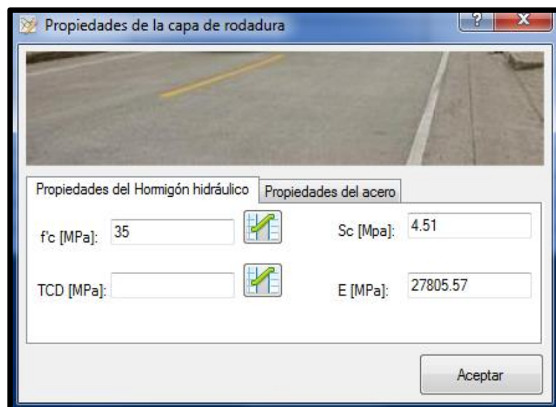
Figura 5.2 Propiedades asignadas al hormigón hidráulico.
