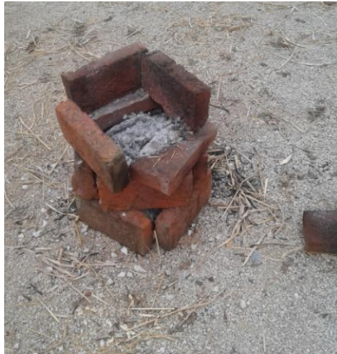
Figura 3. 2 Horno manual para la cocción de la piedra caliza
