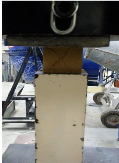
Figura 2. 2 Espécimen sometido a compresión
