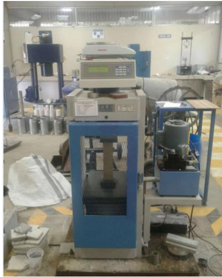
Figura 2. 1 Maquina de ensayo para resistencia a compresión
