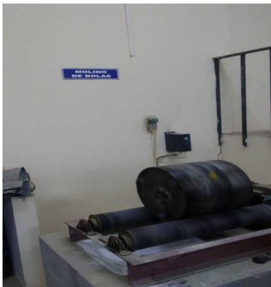
Figura 3. 5 Molienda de bolas empleada para la obtención del material fino
