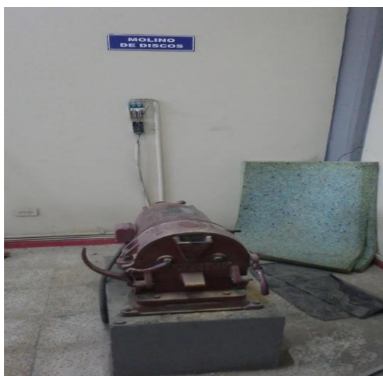
Figura 3. 4 Molino de disco usado para la tritución fina del material
