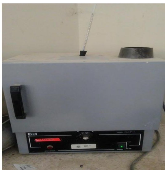
Figura 3. 9 Horno a una temperatura de 90°C para el curado de la mezcla
