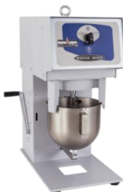
Figura 3. 8 Tazón mezclador para la elaboración de especímenes
