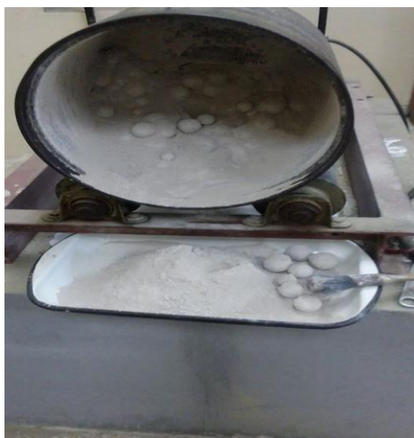
Figura 3. 6 Extracción del material de la molienda
