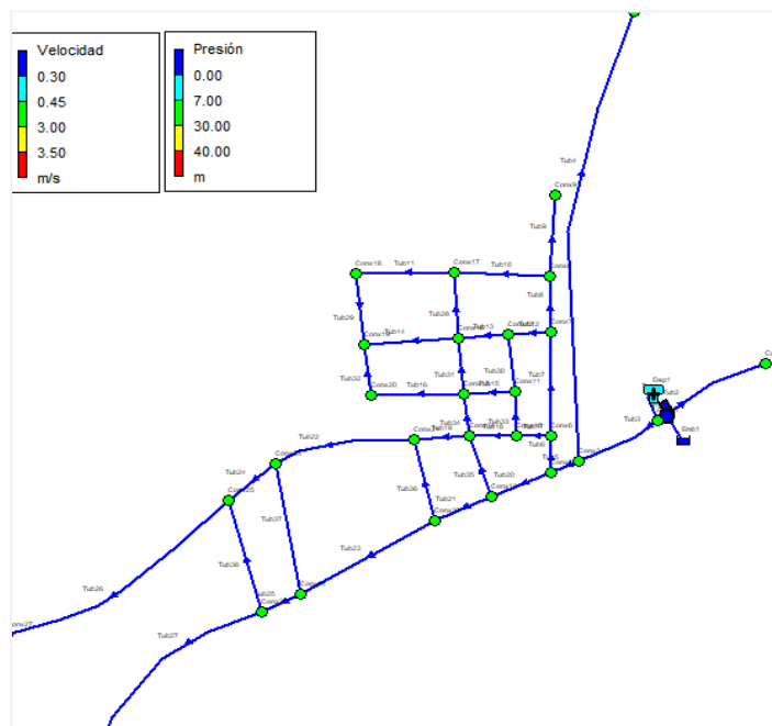
Figura 3. 4 Esquema de caudales y demandas obtenidas en el software EPANET 2.0 Fuente: González, M., Pinargote, D., 2018.
