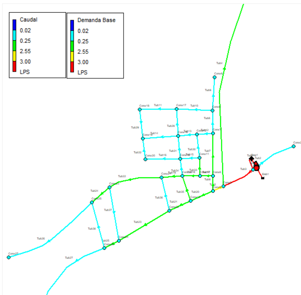
Figura 3. 10 Esquema de resultados de los caudales y demandas bases en la red obtenidos por la simulación régimen variable a la hora pico 8:00 con el programa EPANET 2.0
