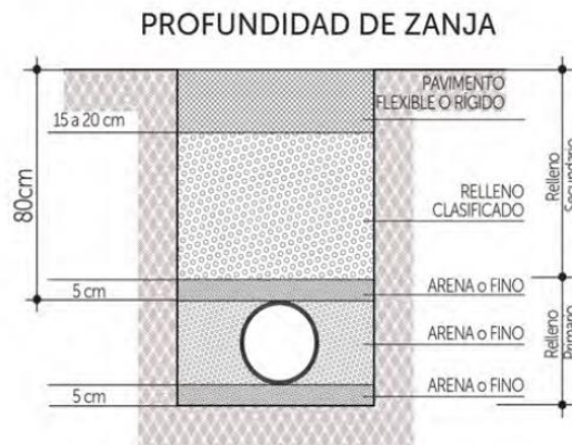
Figura 4. 19 Profundidad de zanja recomendada Fuente: Plastigama, 2015
