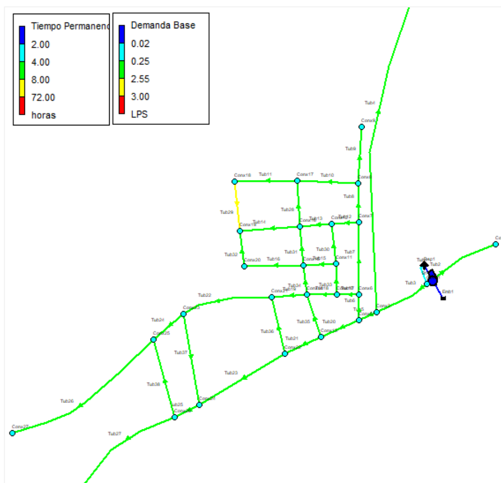
Figura 3. 11 Esquema de resultados de los tiempos de permanencia y demanda base en la red, obtenidos por la simulación régimen variable a la hora pico 8:00 con el programa EPANET 2.0
