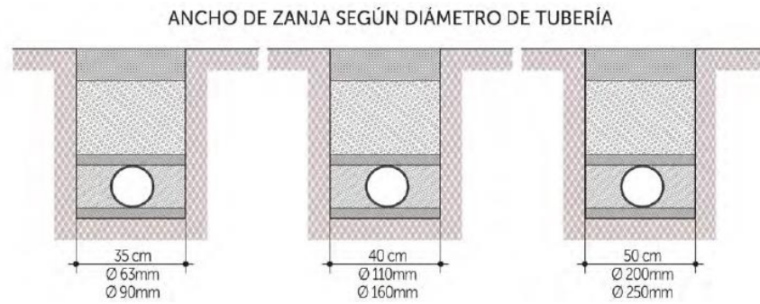
Figura 4. 18 Anchos de zanjas recomendados Fuente: Plastigama, 2015
