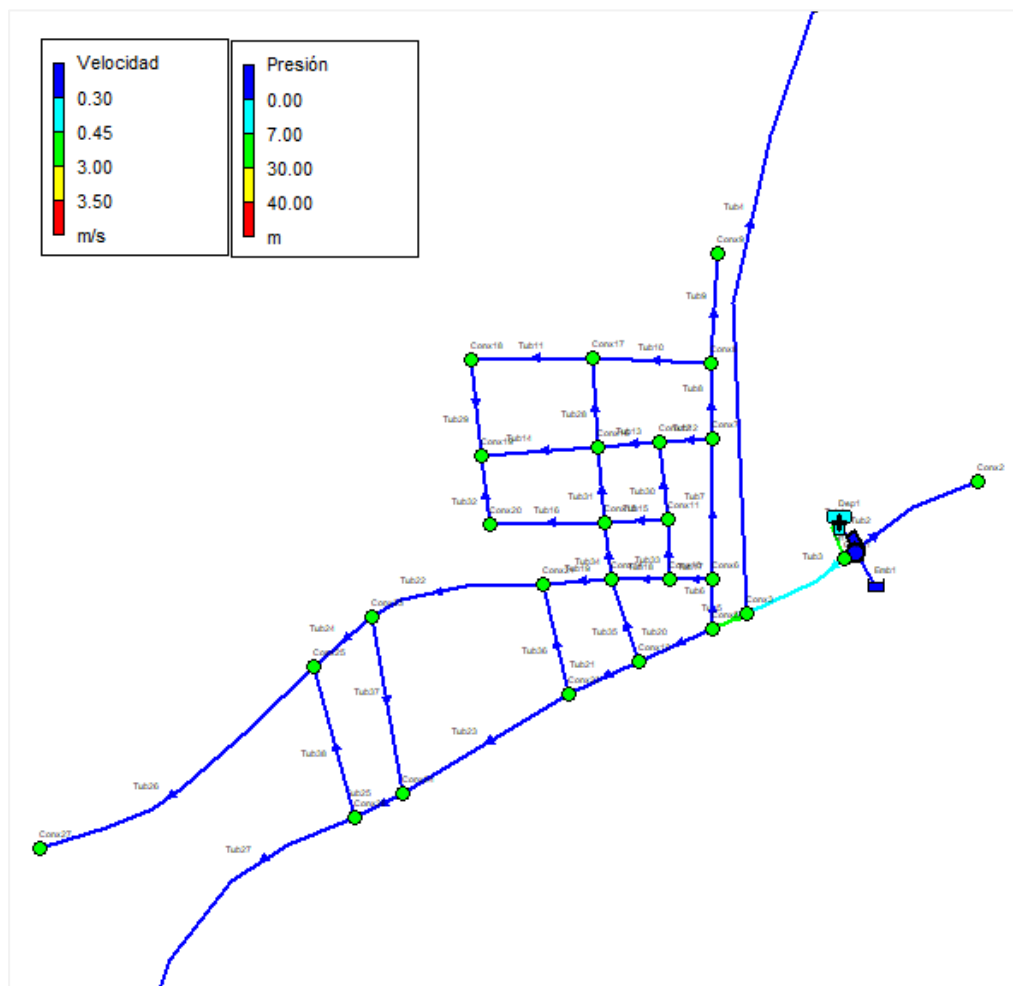
Figura 3. 9 Esquema de resultados de las velocidades y presiones en la red obtenidos por la simulación régimen variable a la hora pico 8:00 con el programa EPANET 2.0
