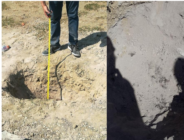
Figura 7.5 Calicata realizada en el terreno. Fuente: García, J., Marín, S., 2017.
