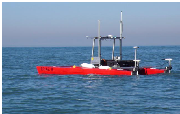
Figura 1.9 ROAZ II, embarcación autónoma de superficie [17]
