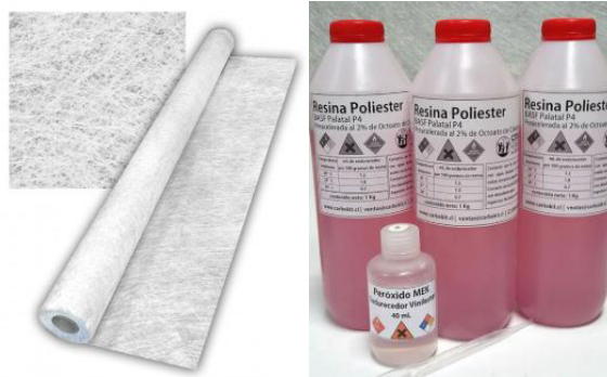
Figura 2.8 Fibra de vidrio Mat 300 g/m 2 y Resina poliéster [28]
