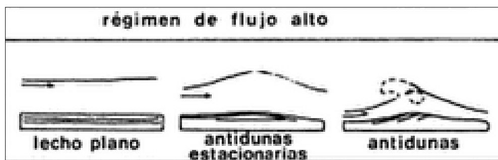
Figura 4.4 Cambios de la forma de los lechos, debido al aumento del caudal, flujo alto.
