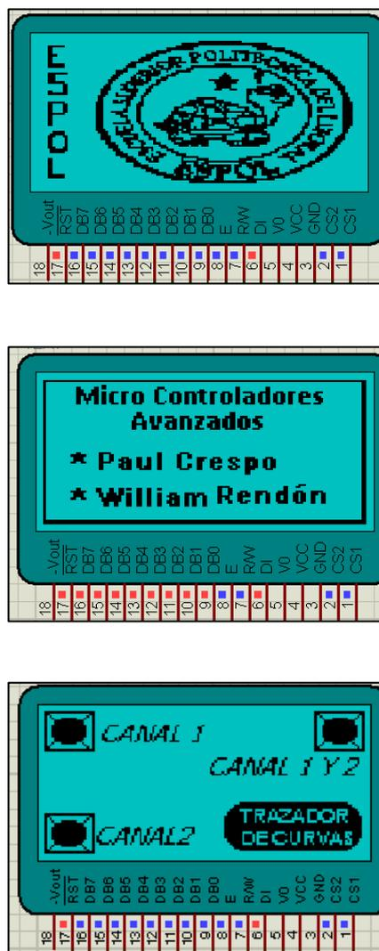
**FIGURA 4-4: Simulación de la secuencia de imágenes en la pantalla GLCD luego de presionar nuestra pantalla táctil.**
