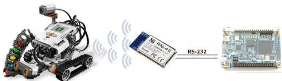
Figura 2-2 modelo de comunicación entre el robot y el control remoto
