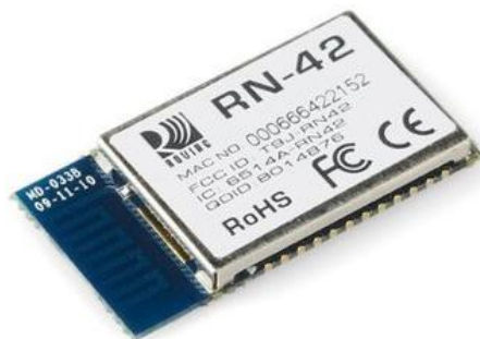
Figura 1- 12 Módulo Bluetooth RN-42
