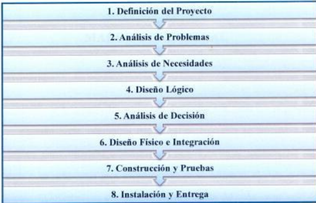
Figura 1.3. Ciclo de Vida del Desarrollo de un Sistema de Información. Fuente: Systems Analysis and Design Methods (Whitten, Bentley y Dittman, 2004).
