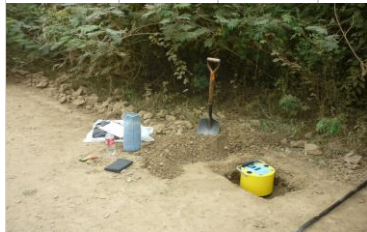
Medición con Geogauge sobre la subrasante.
