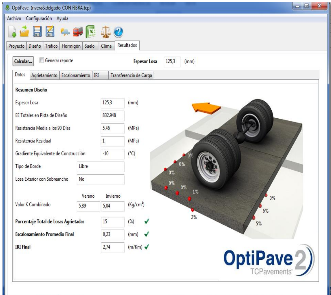
Figura 3.20 Resultado del espesor losas cortas. [Optipave2]
