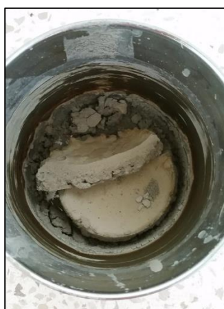
Figura 3.9 Muestra obtenida del pasante No.40 y sometida a temperatura
