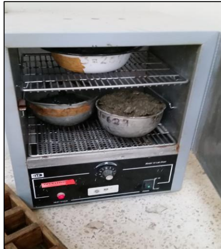
Figura 3.4 Porciones representativas sometidas a alta temperatura
