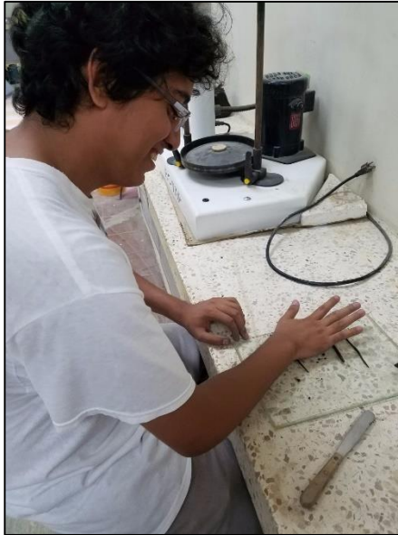
Figura 3.12 Moldeo de los rollitos de suelos sobre la placa de vidrio
