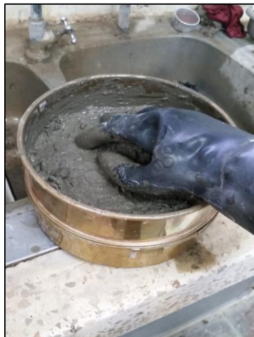
Figura 3.8 Remoción de las partículas superiores al tamiz No. 40
