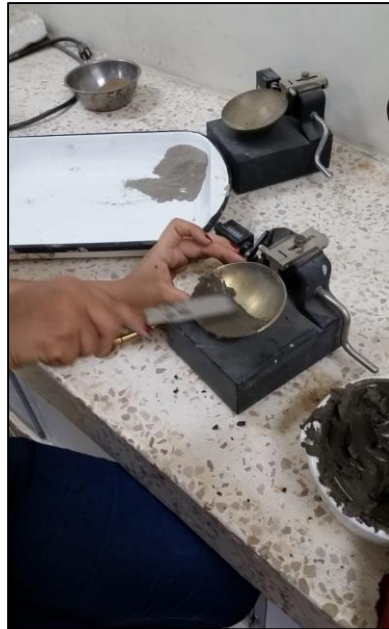
Figura 3.10 Colocación de la muestra en la copa casagrande
