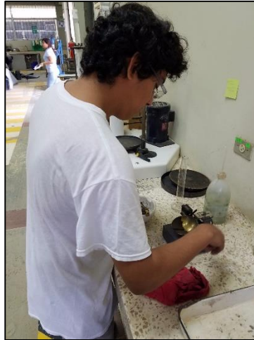
Figura 3.11 Utilización de la copa casagrande
