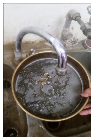
Figura 3.5 Remoción de residuos e impurezas mediante lavado
