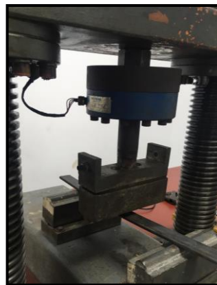
Figura 3.16 Platina sometida a flexión
