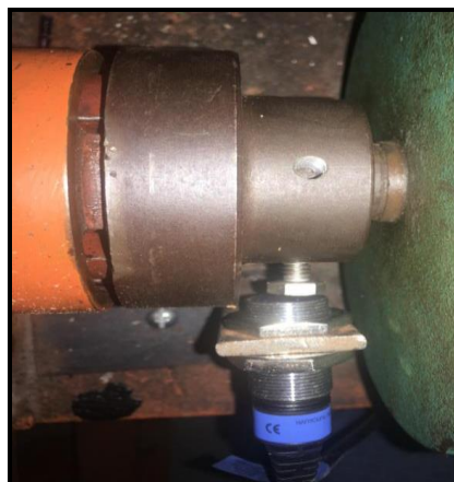
Figura 2.10 Acople rígido y sensor con 1 perno para hacer interferencia.
