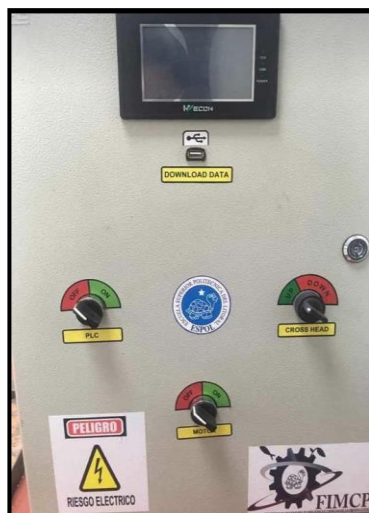
Figura 2.24 Distribución de botones y pantalla sobre caja
