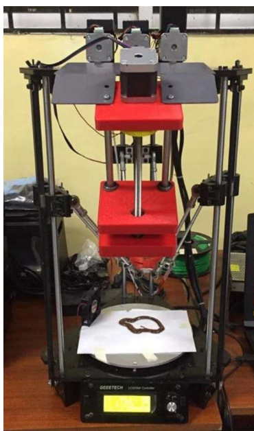
Figura 3.3 Equipo instalado en el sistema de la impresora realizando una figura de chocolate.
