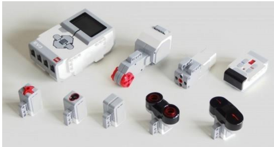
Figura 1.1. Sensores y componentes del LEGO MINDSTORMS EV3 (León, 2013)
