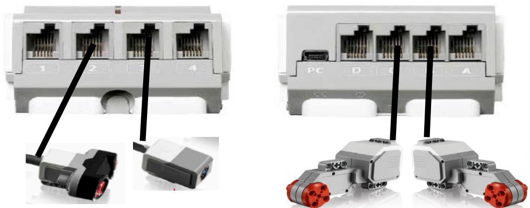
Figura 3. 5 Esquema de conexión de los sensores del EV3
