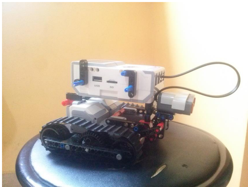
Figura 3. 6. Ensamble de los motores con el Brick y los sensores
