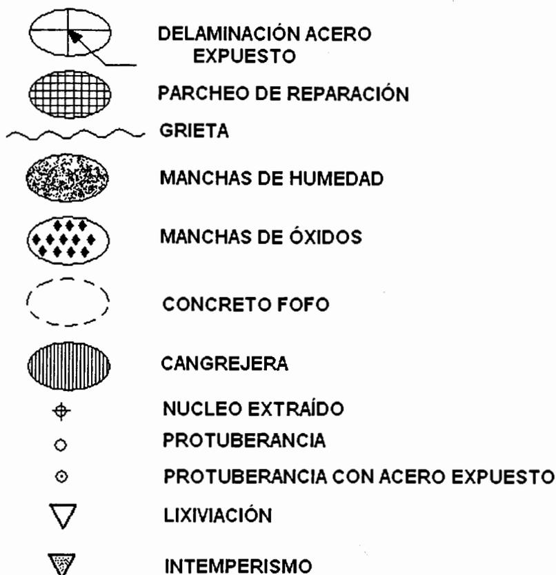
**FIGURA 2.1.2. LEYENDAS DE TIPIFICACIÓN DE DAÑOS <sup>(10)</sup>**
