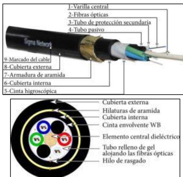
Figura 2.1.4: Estructura del cable de Fibra Óptica.
