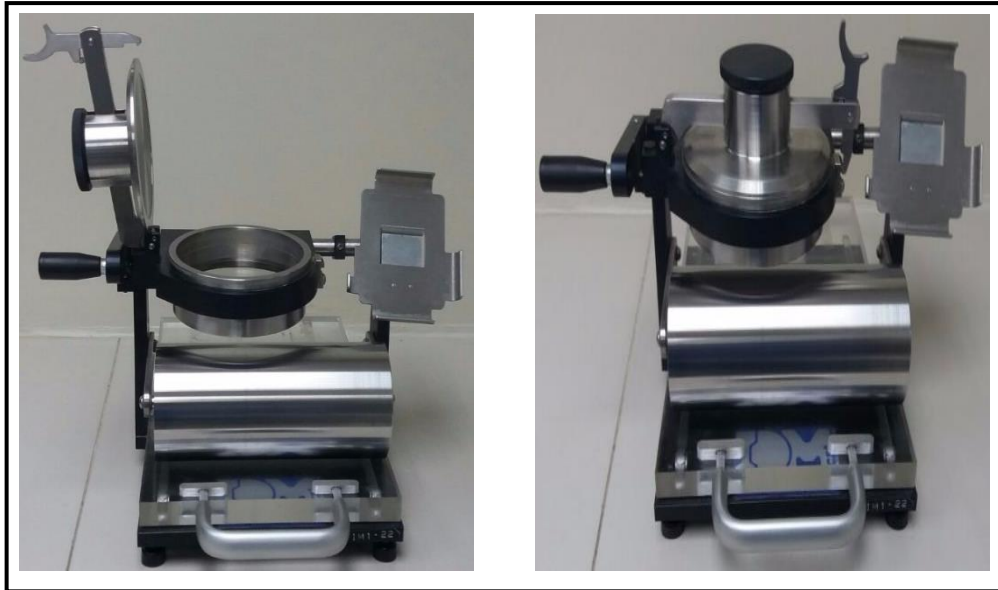
Imagen 2. Equipo semi-automático usado para la medición del encolado con la prueba estandarizada y normalizada de COBB.
