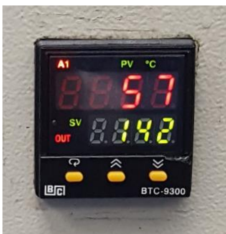
Figura 3.2 Controlador BTC-9300 BRAINCHILD utilizado en lazo de control de temperatura.
