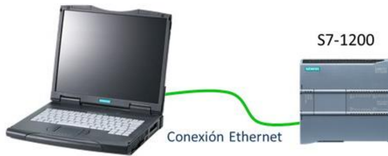
Figura 2.18 Comunicación PC - PLC
