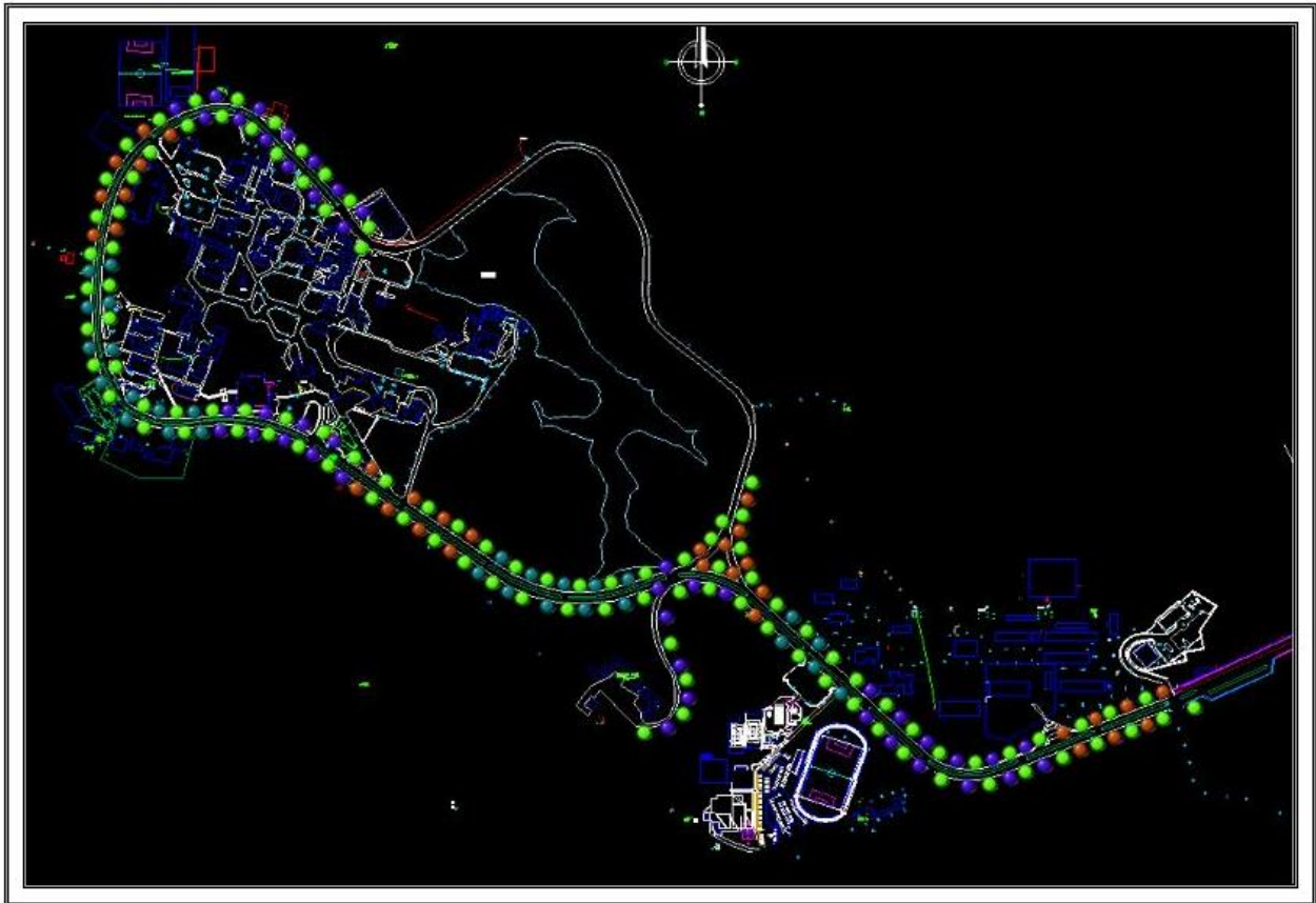
Figura 3.9 Encendido luminarias impares
