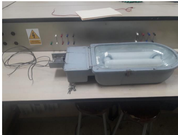
Figura 2.3 Luminaria de inducción magnética ESPOL
