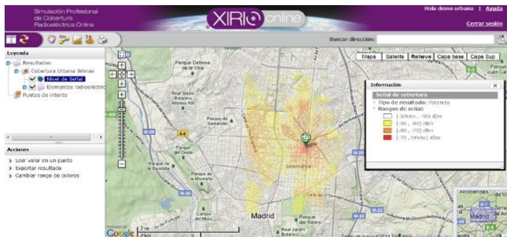
Figura 2.28 Simulador de cobertura radioeléctrica. [26]
