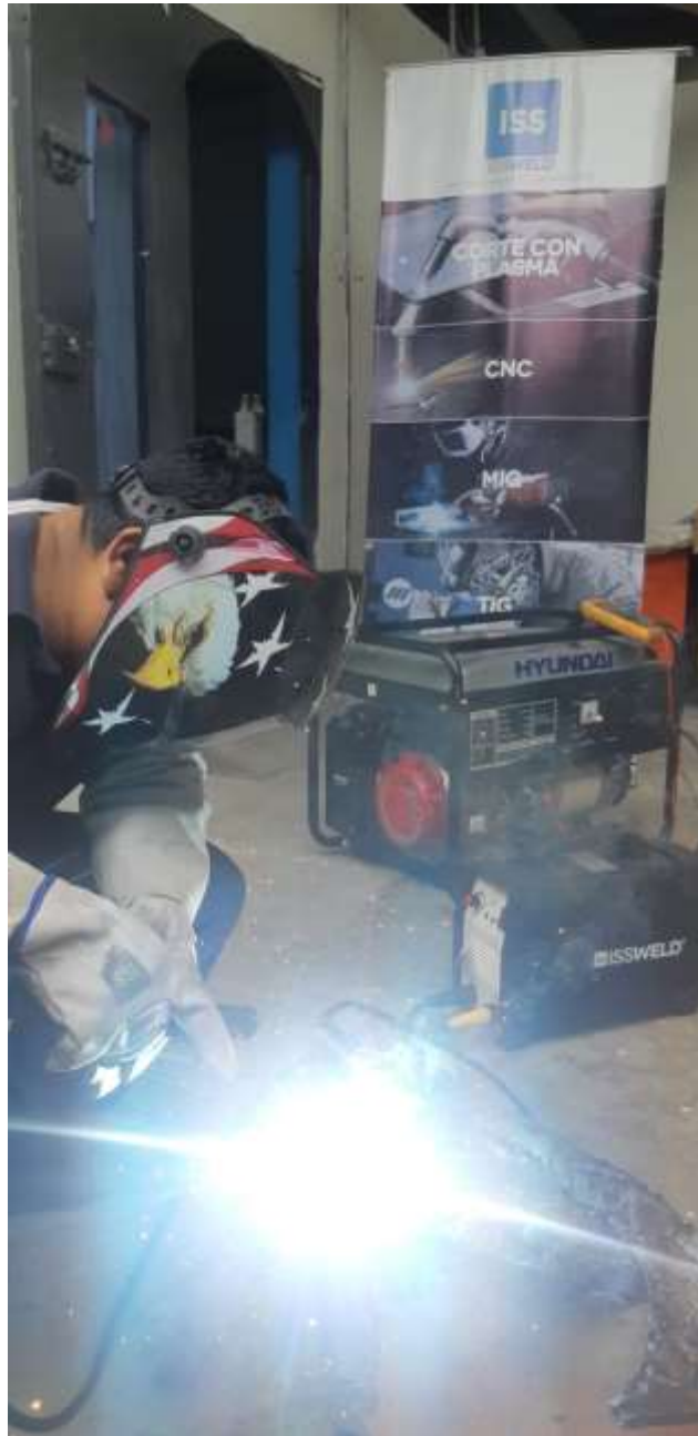
Figura 1.11 Arco eléctrico producido por la soldadura.
