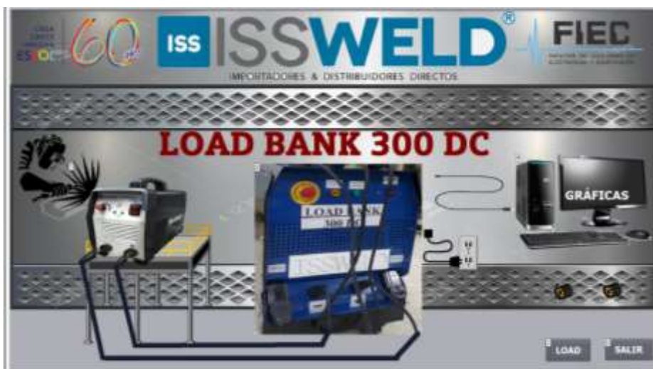
Figura 3.16 Pantalla Principal del sistema SCADA.
