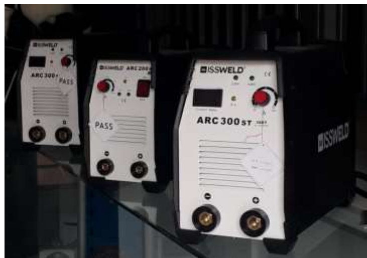
Figura 2.5 Equipos de soldar ISSWELD.
