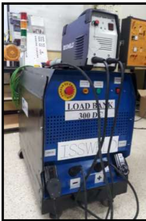
Figura 3.17 LOAD BANK 300 DC en pruebas con la ARC-200ST.
