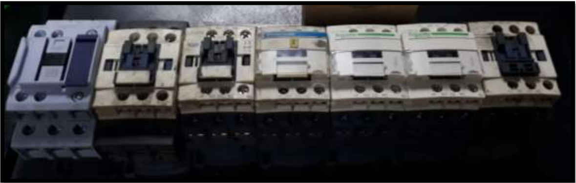
Figura 2.20 Contactores con bobina de 110 y 220 VAC.
