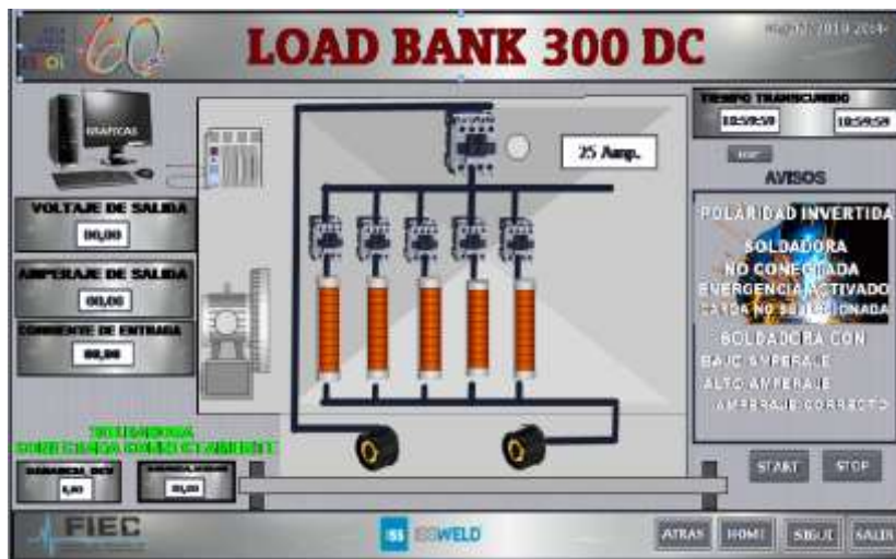
Figura 3.18 LOAD BANK 300 DC desde el SCADA con la ARC-200ST.
