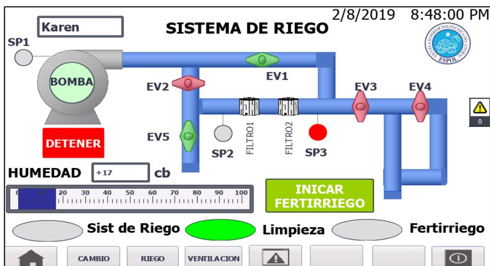
Figura 3.5 Proceso de Limpieza de filtros activado
