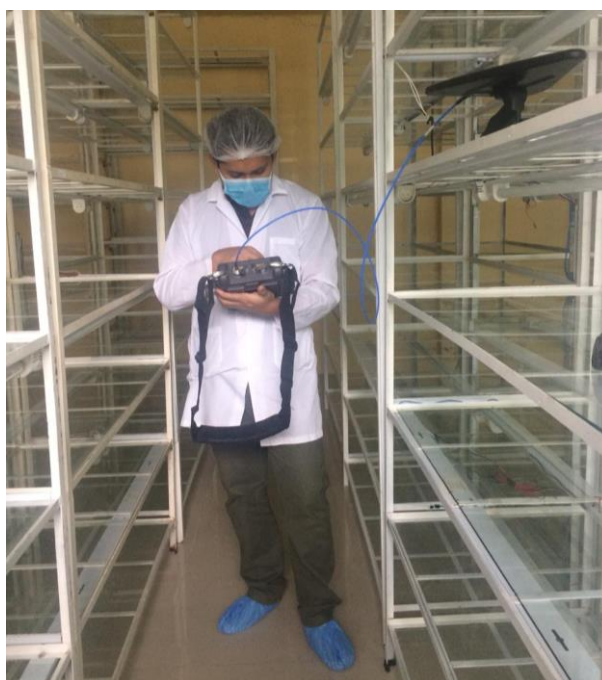
Figura 3. 7. Medición de la potencia recibida al cruzar una repisa sin plantas.
