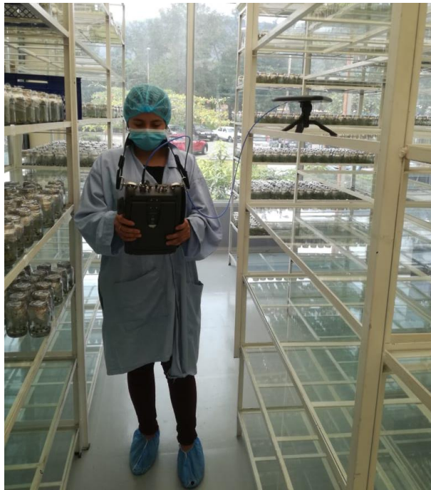
Figura 3. 8. Medición de la potencia recibida antes de cruzar una repisa con plantas.
