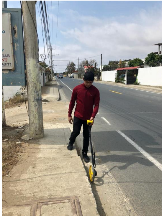
Anexo 1 Medición de distancia entre postes
