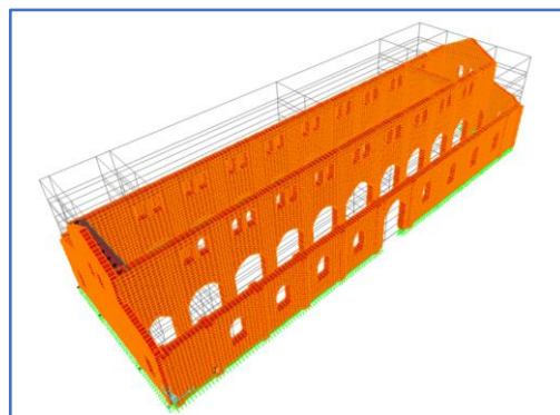
Figura 3.6 Sistema estructural de la iglesia en SAP2000.
