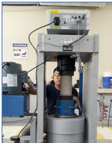
Figura 2.14 Rotura de especímenes a las edades correspondientes.
