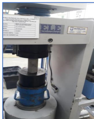
Figura 1.6 Ensayo de resistencia de compresión de núcleo de roca.
