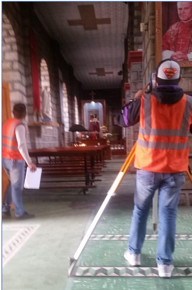
Figura 2.4 Medición de paredes con la Estación Total.
