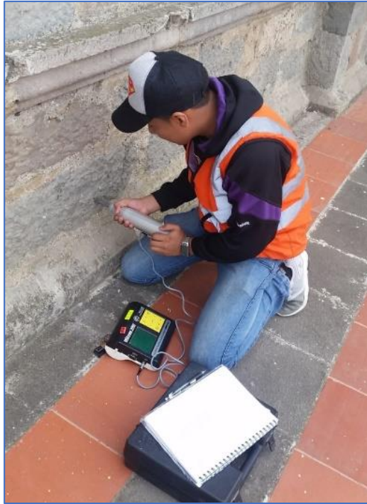
Figura 2.6 Ensayo de esclerómetro a la pared de roca.
