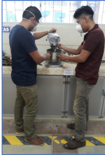
Figura 2.13 Mezclado del mortero a inyectar.
