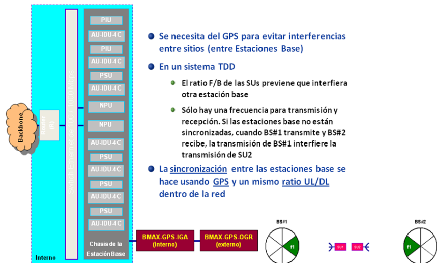
Fig. 4.29.- Sistema de Sincronización mediante GPS.
