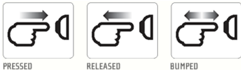
Figura 2-7 Modo de función del Sensor de Tacto
