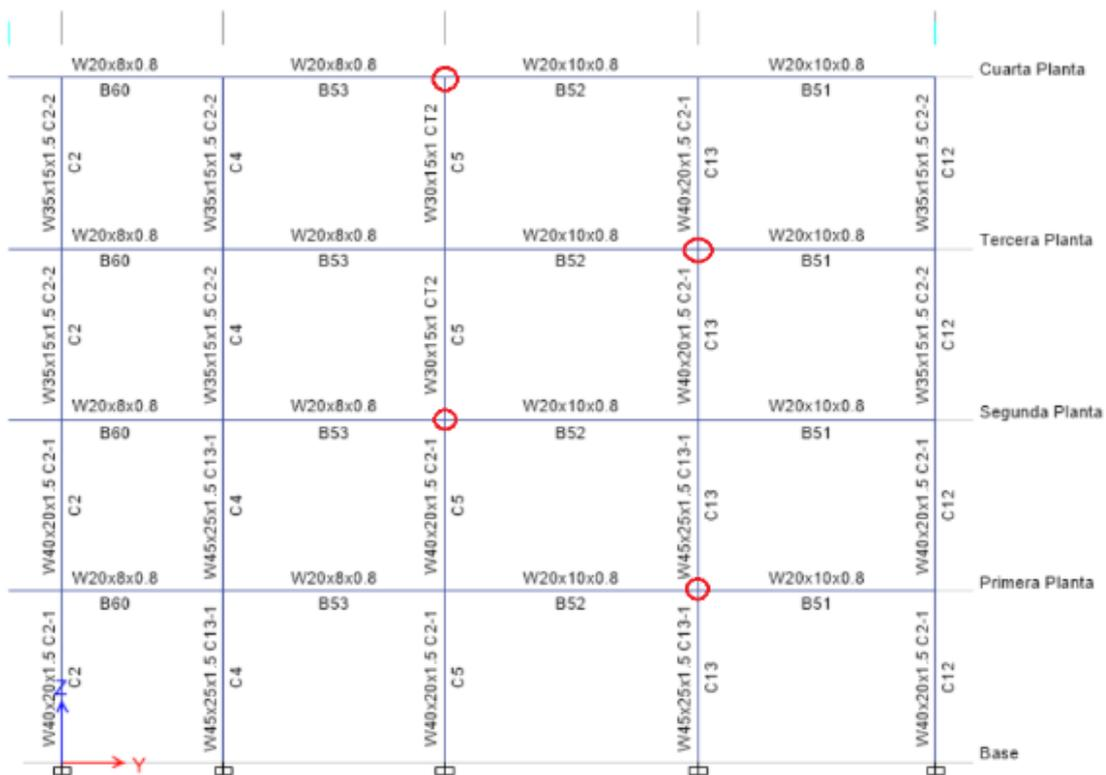
**Figura 2.14: Conexiones de los Pórticos IMF**
