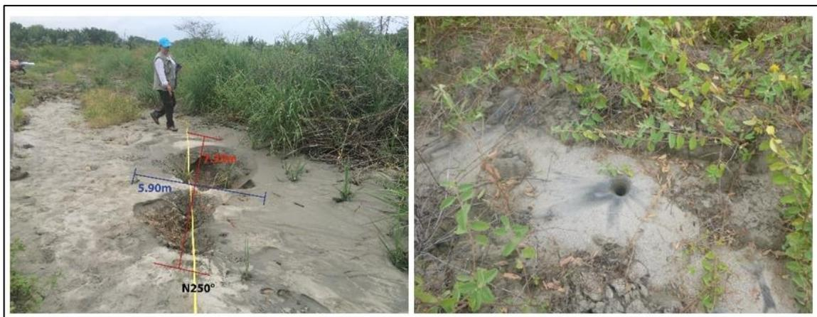
**Figura 1.8: Suelos con presencia de Licuefacción después del terremoto del 16 abril, Zona: Litoral de Manabí. Se puede presenciar volcanes de arena y efectos de licuefacción.**
