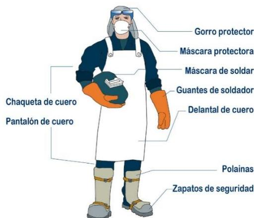
**Figura 5.14: Equipos de Protección para soldadura**
