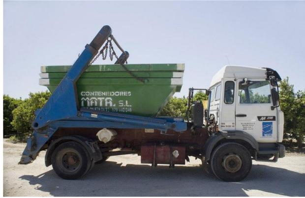
**Figura 5.6: Contenedor para desechos de construcción**
