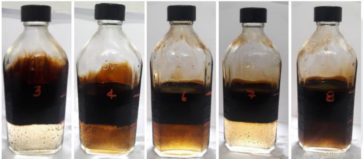
Figura 3.27. Resultado de la mezcla pruebas 03, 04, 06, 07 y 08 de fluido de completación con nanotecnología del PLAB-036 [Dynadrill S.A., 2018]
