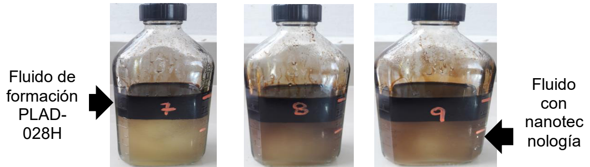
Figura 3.16. Resultado de la mezcla pruebas 07, 08 y 09 de fluido de completación con surfactante “I” del PLAD-028H [Dynadrill S.A., 2018]
