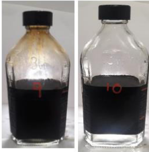
Figura 3.28. Resultado de la mezcla pruebas 09 y 10 de fluido de completación con nanotecnología del PLAB-036 [Dynadrill S.A., 2018]
