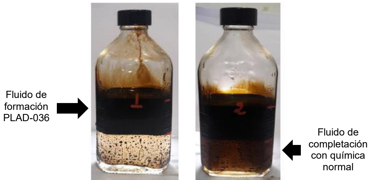
Figura 3.4. Resultado de la prueba 01 y 02 del PLAB-036 [Dynadrill S.A., 2018]
