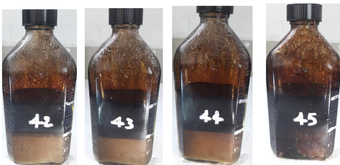
Figura 3.26. Resultado de la mezcla pruebas 42, 43, 44 y 45 de fluido de completación con nanotecnología del PLAD-033 [Dynadrill S.A., 2018]
