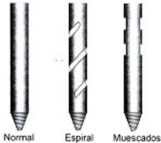
**Fig. 1.4.8.1.1 Tipos de barras de perforación**
