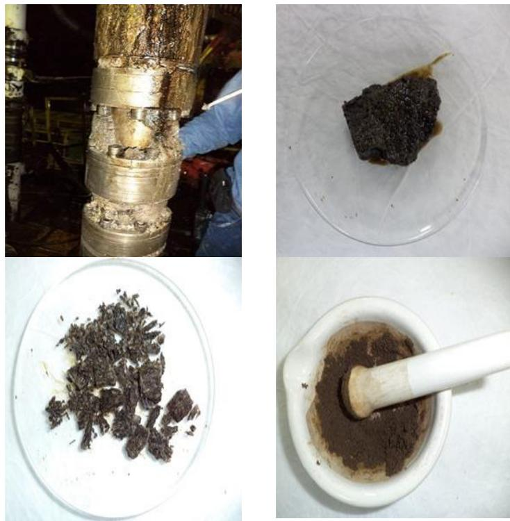
**Fig. 3.2.1.1 Extracción de sólidos y residuos como escala del equipo de fondo**
