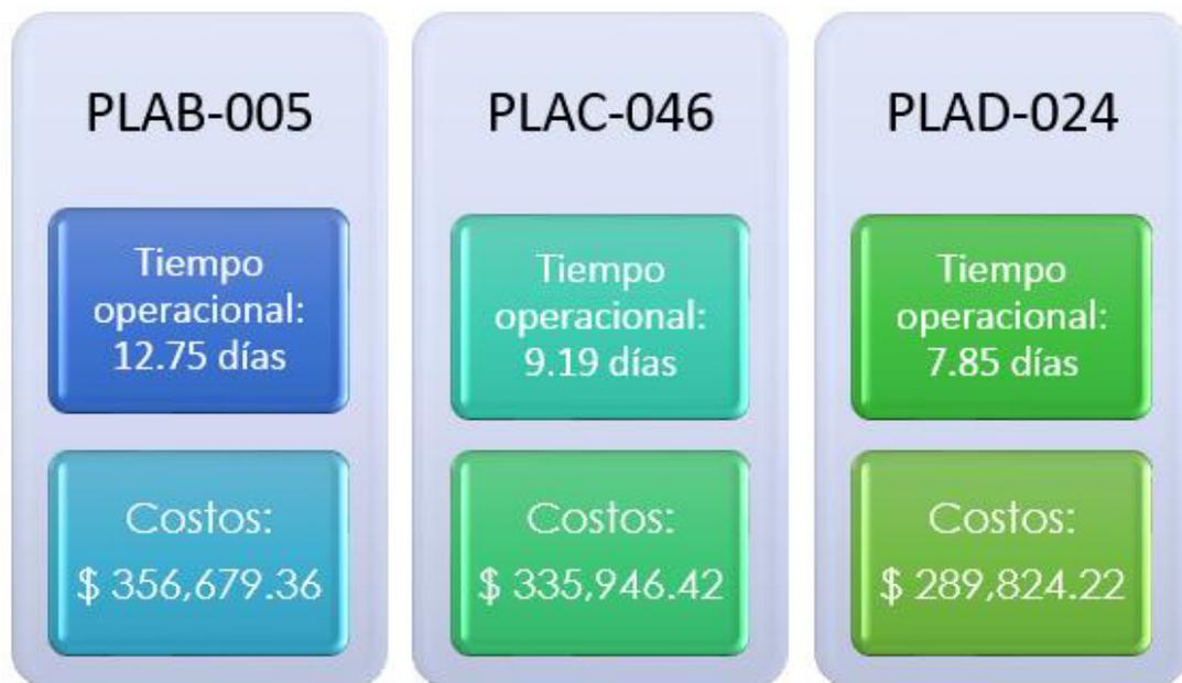
**Fig. 3.8.3.3 Esquema de costos y tiempo operacional de la técnica Clean & Perf en los pozos del campo Palo Azul (Franco, V. & Balón, R. (2019))**
