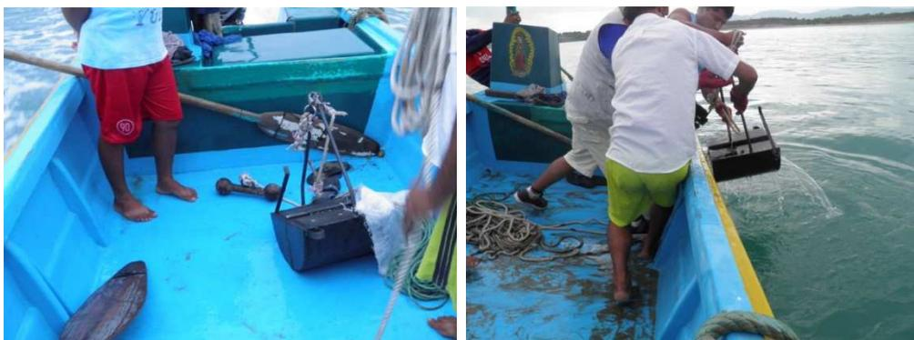
**Figura 10.** Operación de instrumento “van veen” y extracción de la muestra de sedimento EJ-S-02. Coordenadas UTM WGS 1984, 541.093mE, 9.896.074mN.
