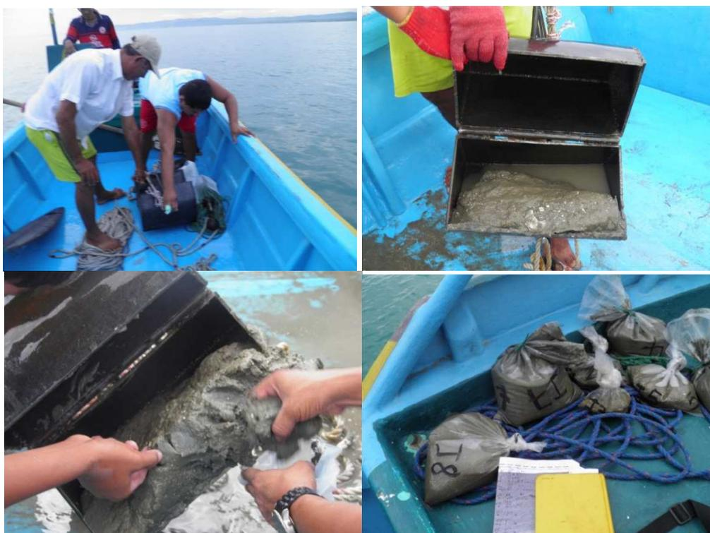
**Figura 11.** Obtención y selección de un kilo de muestra de sedimento para análisis granulométrico, al inicio las muestras fueron enumeradas con la abreviación “J” en laboratorio han sido cambiadas a la abreviación “EJ-S-08”, de acuerdo al posicionamiento en sitio. Coordenadas UTM WGS 1984, 541.007mE, 9.896.008mN.
