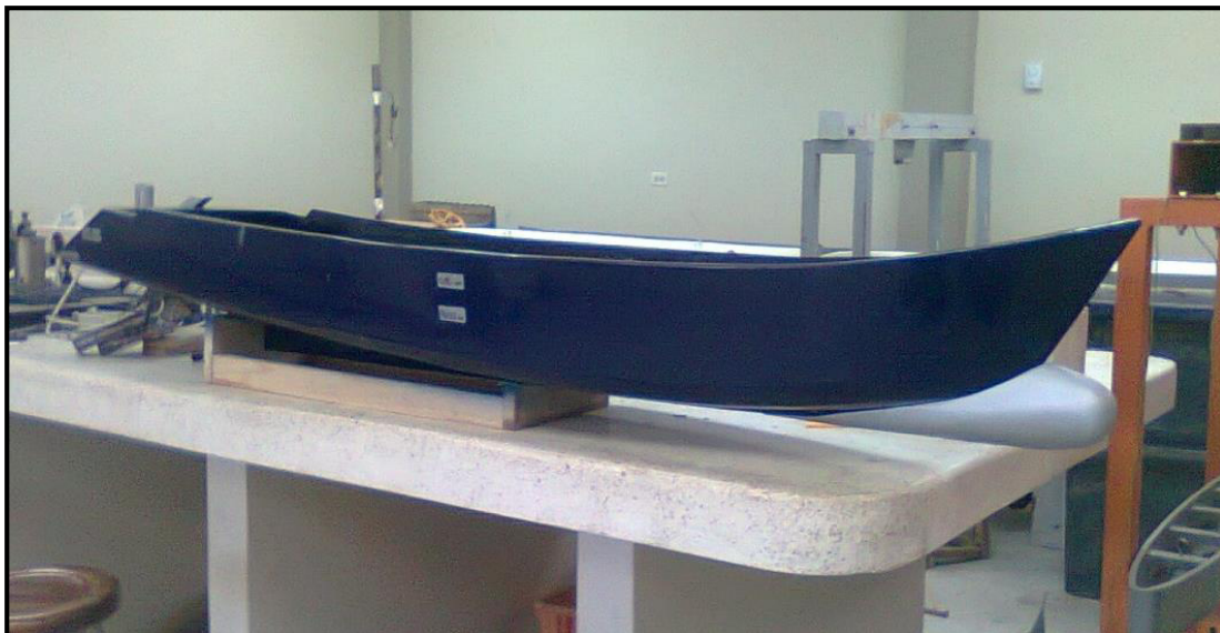
Figura No. 3 Modelo a Escala de la Embarcación Prototipo.
