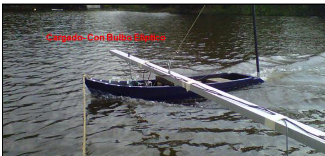
Figura No. 34c Ensayo Cargado – Con Bulbo Elíptico
