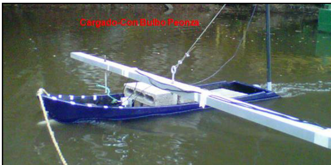
Figura No. 34b Ensayo Cargado – Con Bulbo Peonza
