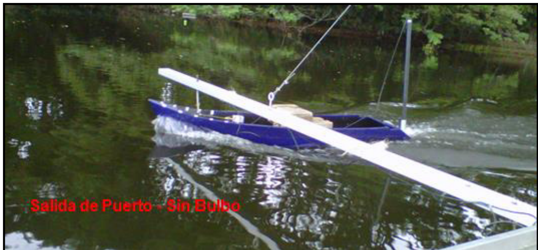
Figura No. 32a Ensayo Salida de Puerto – Sin Bulbo de proa
