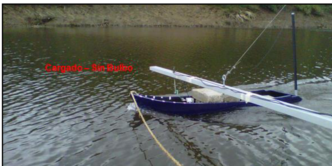
Figura No. 34a Ensayo Cargado – Sin Bulbo de Proa
