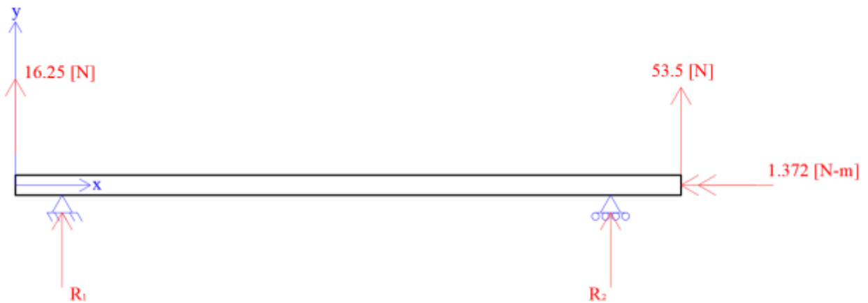
Figura A. 18. Modelado del árbol del piñón en el plano XY
