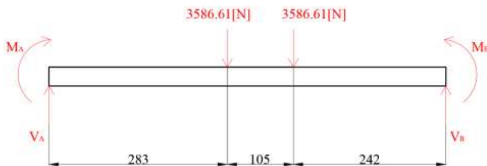
Figura A. 24. Modelado de viga doblemente empotrada
