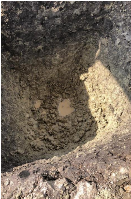
Figura 2.3 Calicata hecha en el terreno
