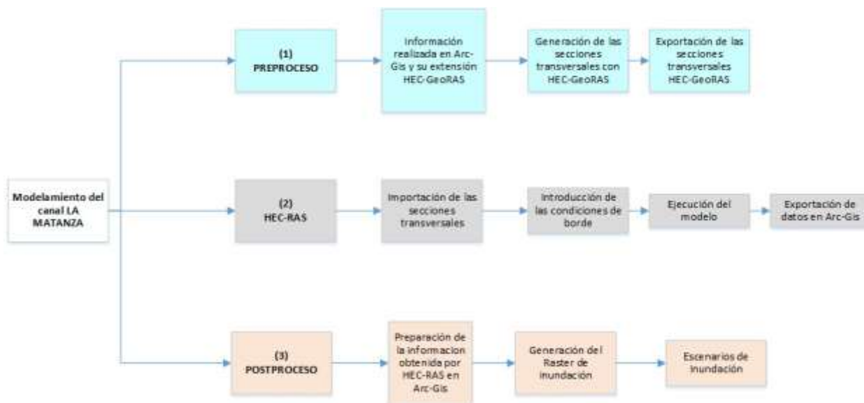
Figura 2.13 Flujo de proceso para el modelo hidráulico [Autora, 2021].
