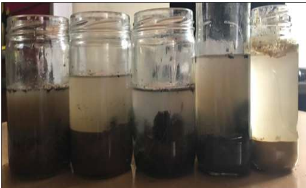
Figura 3.2 Prueba de botella (sedimento agitado) [Autora, 2021].
