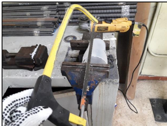
Figura 2.16 Destrucción de los envases para facilitar los cortes
