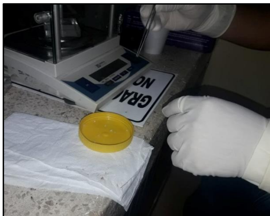
Figura 2.7 Uso de guantes y pinzas para evitar alguna contaminación
