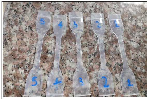
Figura 2.18 Muestras cortadas según la norma ASTM 638-4
