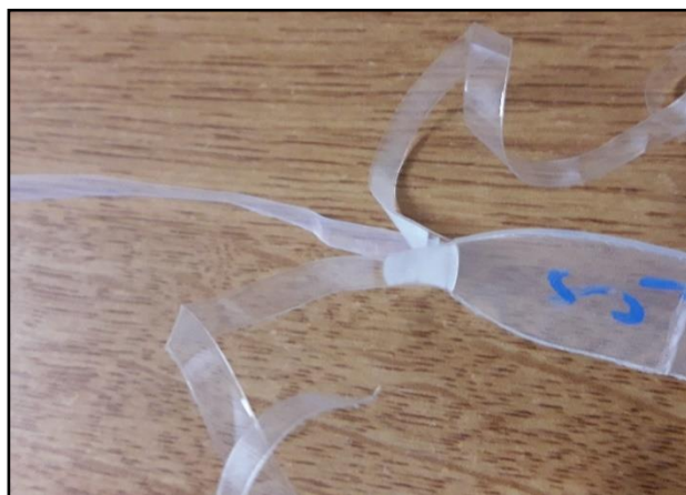
Figura 3.17 Probeta dañada luego de ser analizada en la máquina universal
