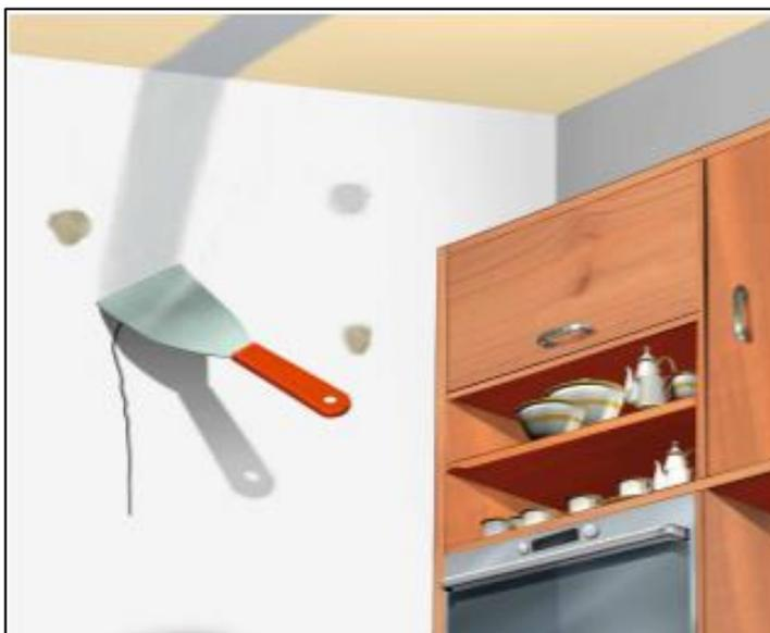
**Figura 3.47 Detalle para sellado de fisuras (SIKA)**
