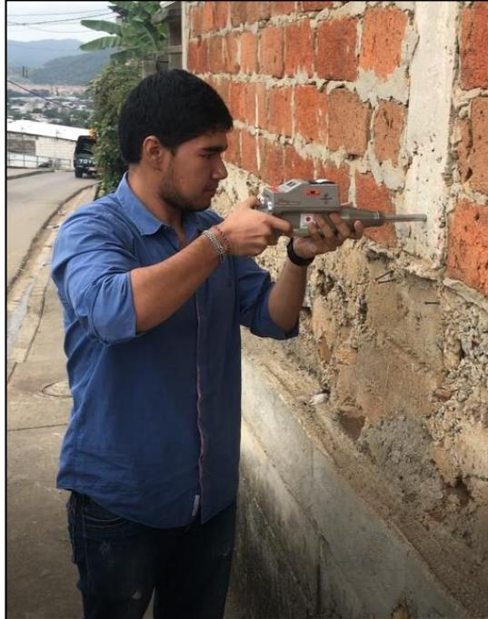
**Figura 2.27 Ejecución del ensayo del martillo de rebote (Autores)**
