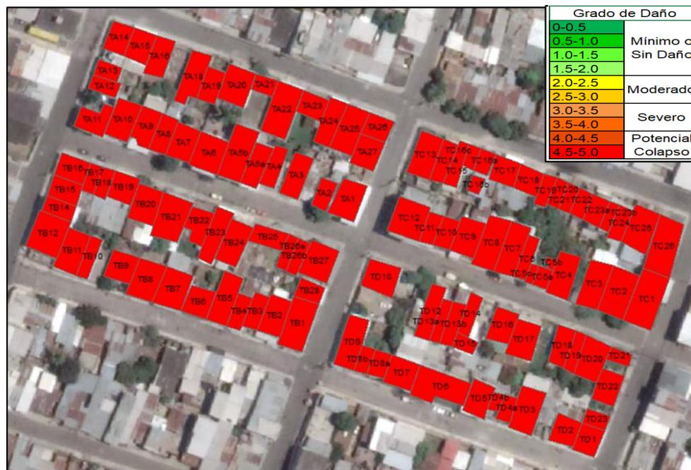
Figura 3.27 Grado de Daño para Sismo de Intensidad IX, Trinitaria (Desarrollado en ArcGIS)
