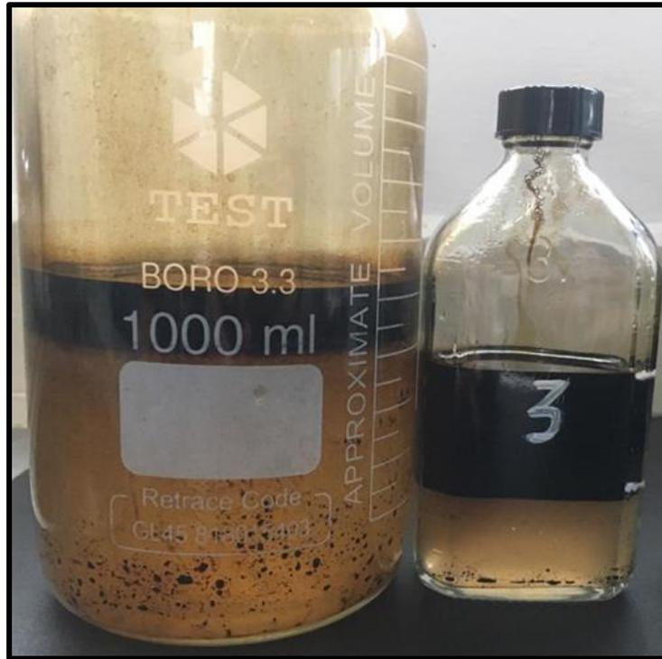
**Figura 3-3 Comparación del fluido de control convencional con los resultados de la prueba de emulsión a la muestra 3.**
