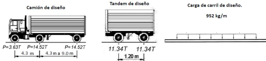
Figura 2. 13 Camión de diseño HS-22-40. Fuente: AASHTO-LRFD-SI-2007
