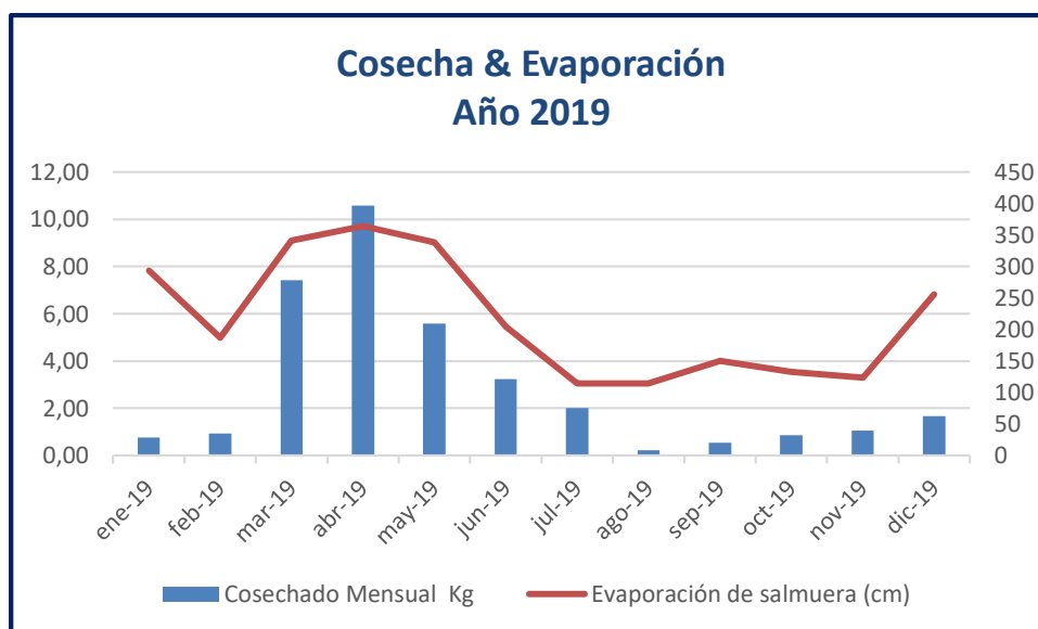
Figura 4.21 Relación Cosecha y Evaporación de Salmuera Año 2019 Fuente: Datos obtenidos en lecturas diarias realizadas por la empresa
