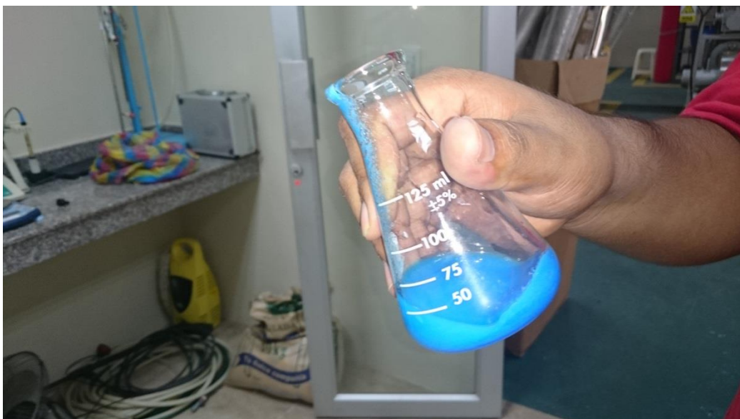
Anexo 8.- Cristales de sulfato de cobre penta hidratado formados en el cristizador.
