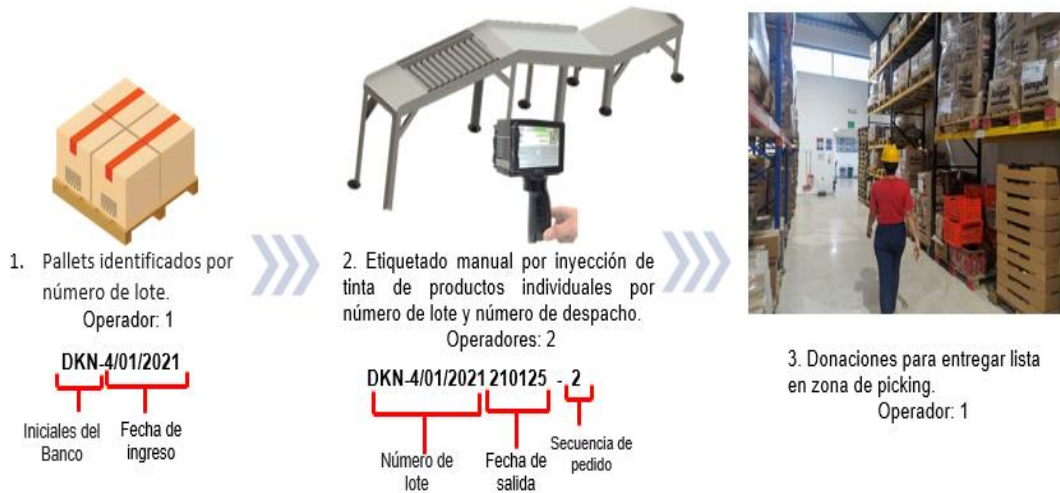
Figura 3. 9 Flujo de identificación de productos al ingreso y antes de su distribución [Elaboración propia]
