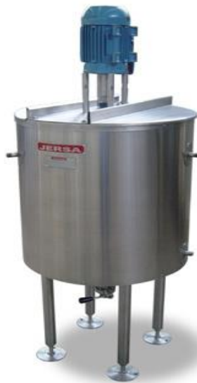
Figura 3.18: Tanque de mezclado
