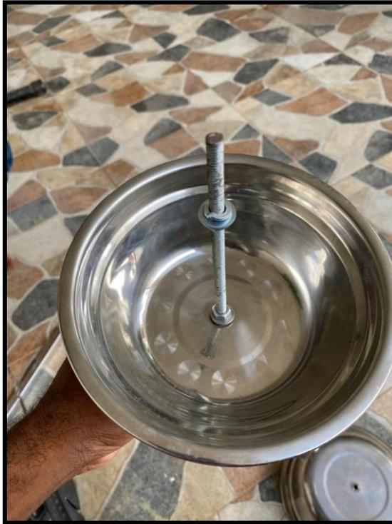
**Imagen 2 Interior del Muestreador Pasivo**
