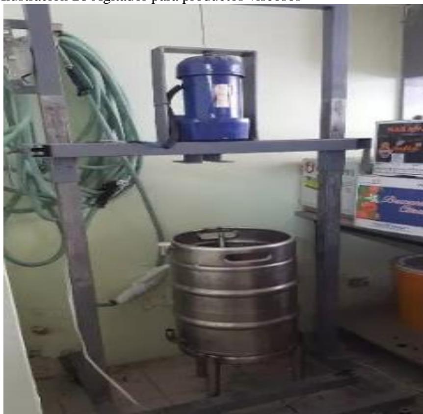
Ilustración 26 Agitador para productos viscosos
