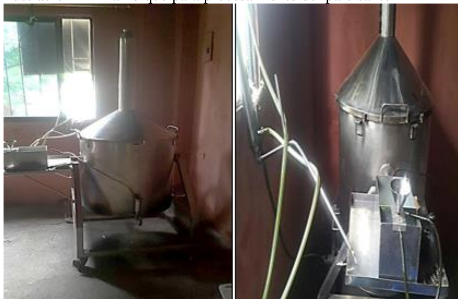
Ilustración 11 Alambique para procesamiento del palo santo
