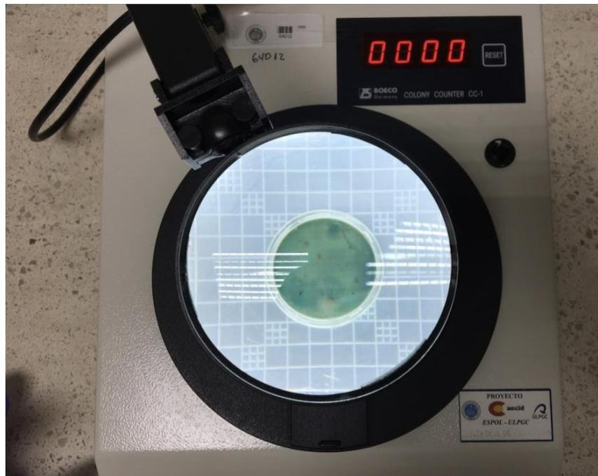
**Figura 2.3: Colony Counter (BOECO) para el conteo de unidades formadoras de colonia. Laboratorio de Aguas de la FCNM-ESPOL**
