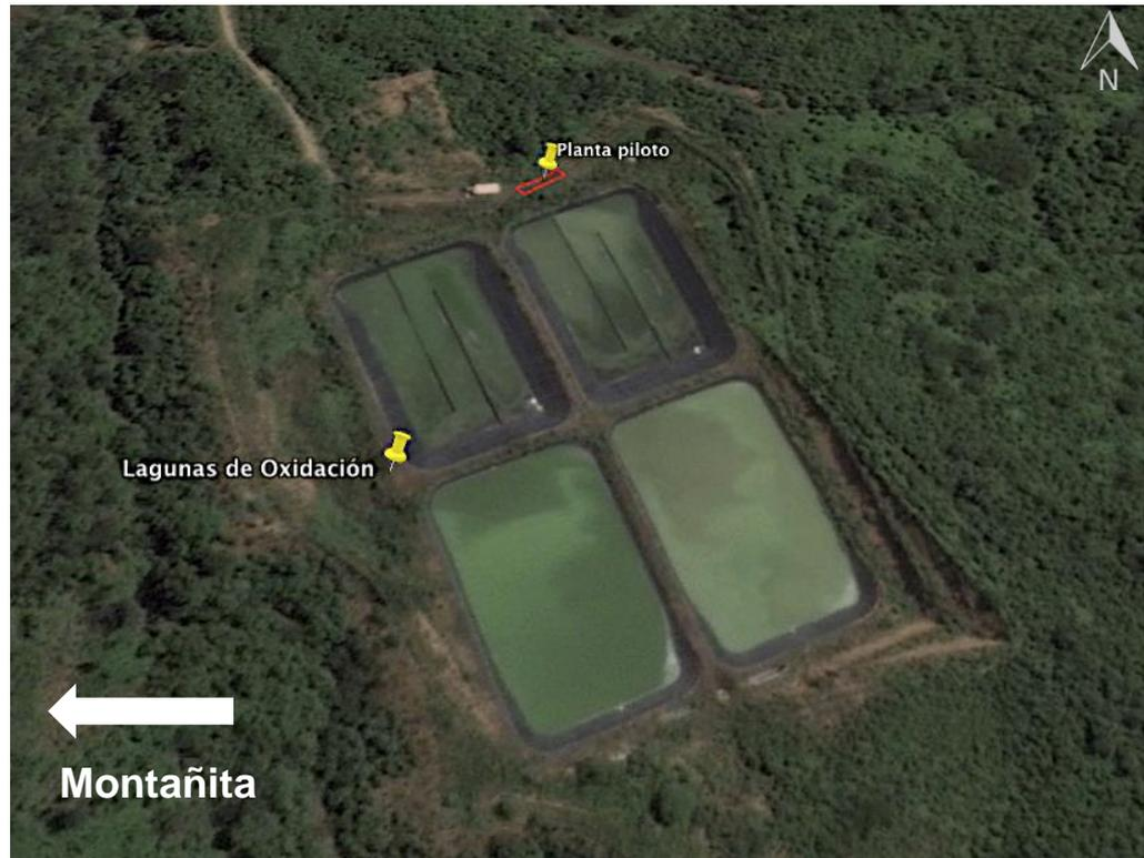
**Figura 2.1: Ubicación de la planta piloto con respecto a las lagunas de oxidación. Imagen tomada de Google Earth**
