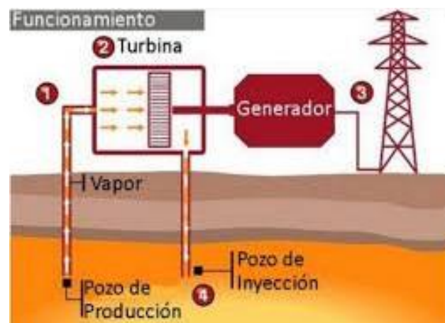
Figura 2.14. Esquema técnico de una central geotérmica Fuente: data:image/jpeg;base64,/9j/4AAQSkZJRgABAQAAQABAAD
