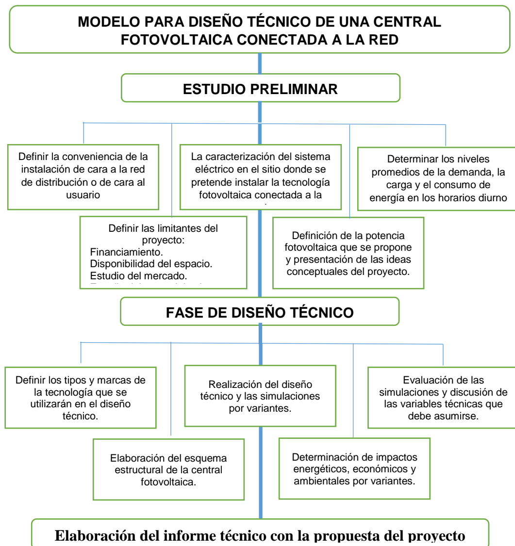
Figura 3.8 Modelo de trabajo para el diseño de una central fotovoltaica conectada a la red Fuente: Elaborado por los autores en base a información de: (Rodríguez and Vázquez, 2018)
